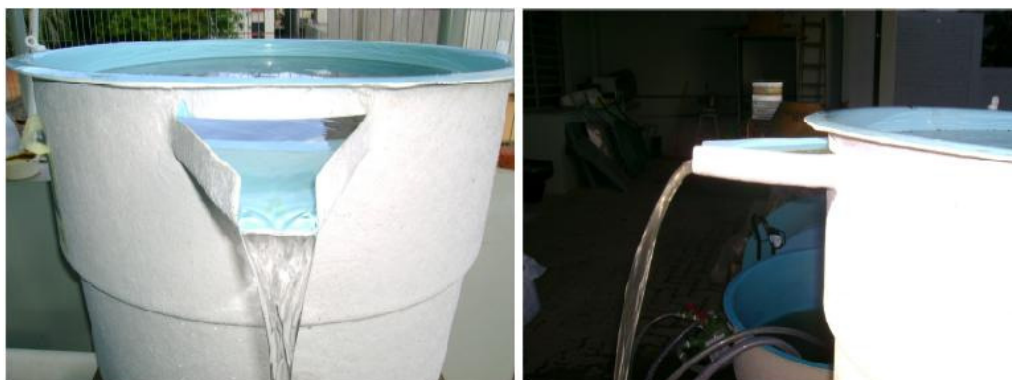
Figura 9 – Vista frontal e lateral da calha coletora de resíduos sólidos.
