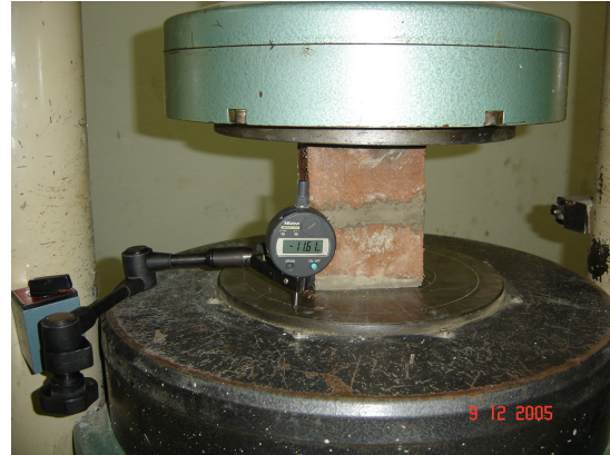
Figura 10. Detalhe do relógio acoplado à prensa hidráulica.
