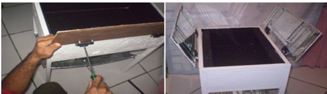
Figura 4.6 – Fixação dos espelhos refletores. Fonte própria.
