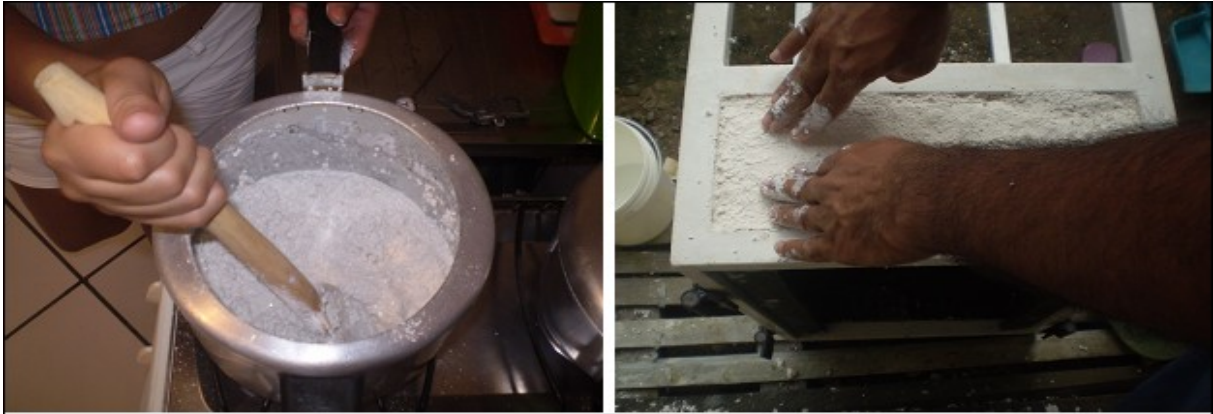
Figura 4.5 – Elaboração e aplicação do compósito isolante. Fonte própria.
