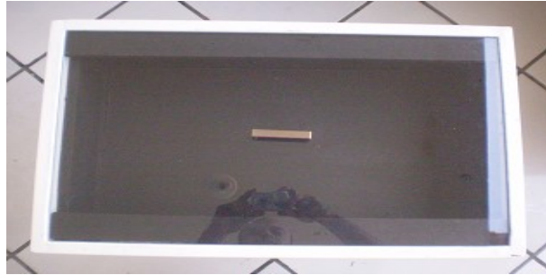
Figura 4.7 - Superfície coletora. Área total 0,2016 m 2 .
